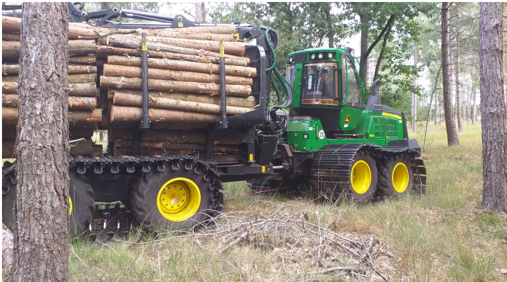
Een achtwielige forwarder met 80 cm brede banden levert een druk op van ongeveer 850 gram per cm^2 . Als de bougie wordt verlengd en er dichte tracks van (voor) 100 cm en (achter) 110 cm omgelegd worden, daalt de druk tot een kleine 400 gram per cm^2 (vol beladen). Met deze machine treedt nog steeds significante bodemverdichting op. Bij het werken met vaste oogstpaden is de mate van verdichting op het vaste oogstpad ondergeschikt. Het zorgt wel voor behoud van de kwaliteit van het oogstpad. Foto: Staro Natuur en Buitengebied
